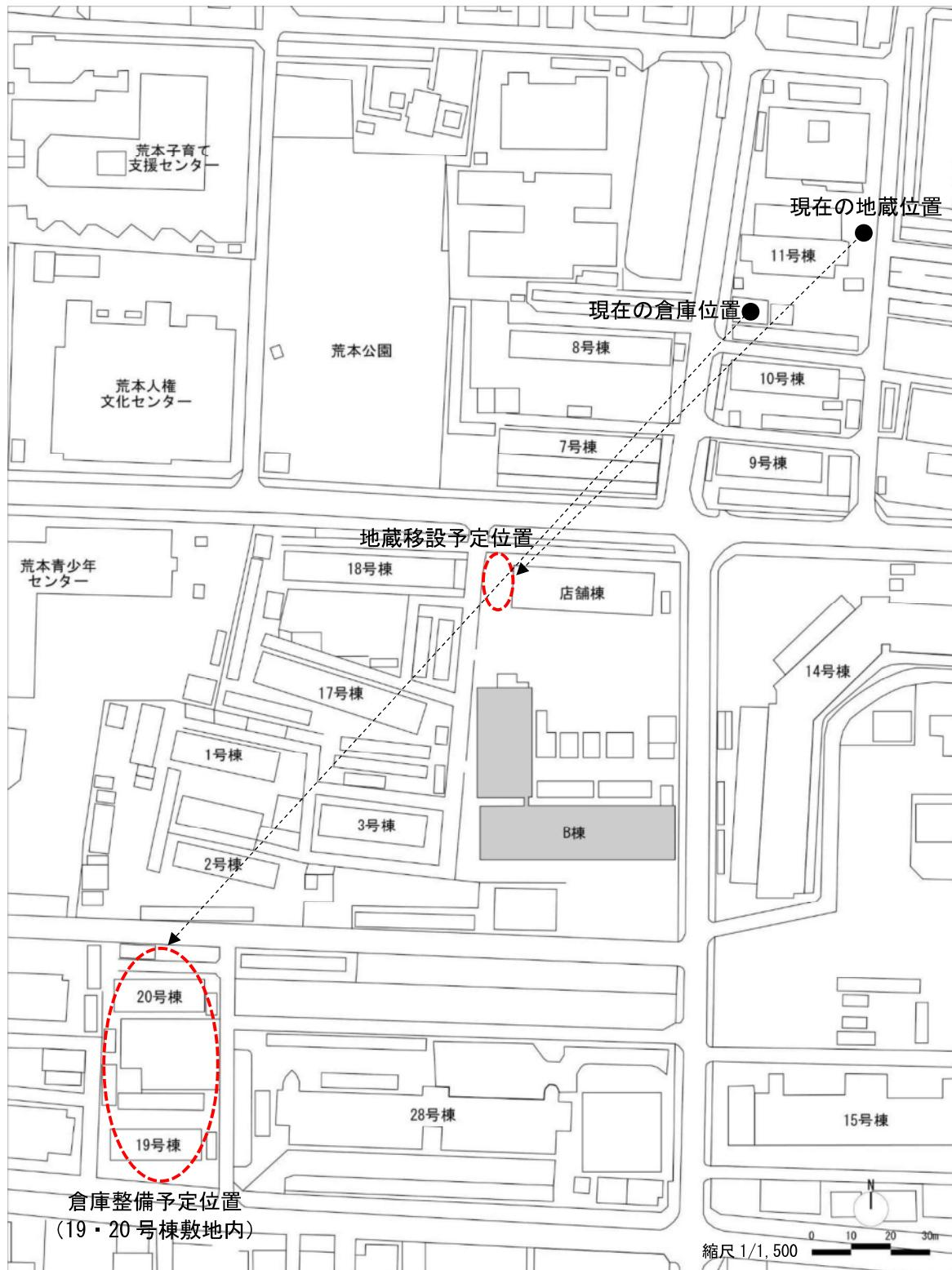
※倉庫は鉄骨造とし、現在の倉庫と同程度（次頁参照）で19・20号棟解体後に整備すること。
