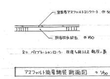
I アスファルト高層舗装断面図 1/50
